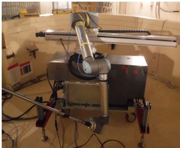
원자로 헤드관통관 Thermal Sleeve 높이측정 장비
