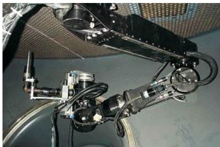
증기발생기내 Tube Sheet 정비작업 (ECT검사, Plugging 등)
